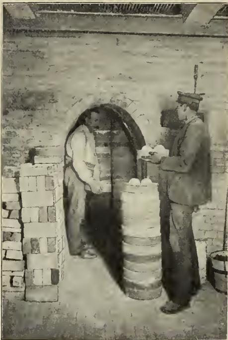
Abb. 9. Einsetzen zum Garbrände. Königl. Porzellanmanufaktur Berlin.
