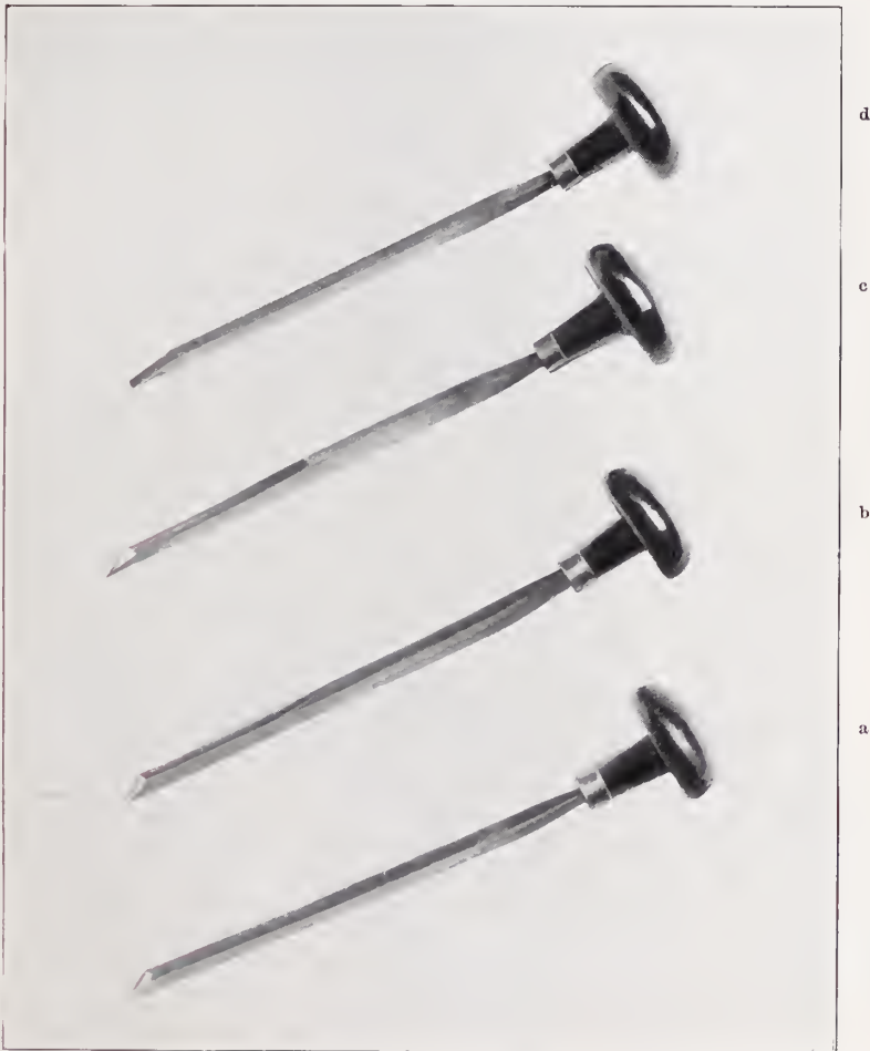
Abb. 58. Beispiele verschiedener Stichel aus dem Kaufhause von Georg Jacob in Leipzig. a. Spitztonstichel Nr. 1, b. Tonstichel Nr. 12, c. Linientonstichel Nr. 5, d. Fadenstichel. (Zu Seite 62.)
