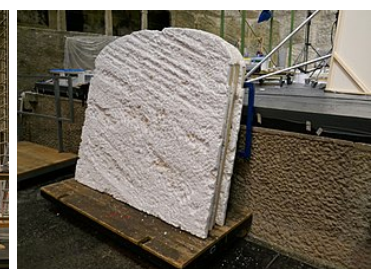
Brett im Stein.. ..aus Holz und Styropor
