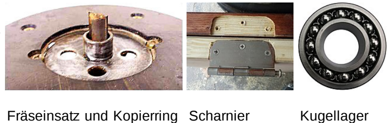
Fräseinsätze, mit und ohne Anlaufring (Kugellager)
