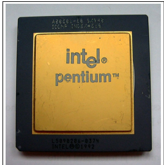
Il Pentium, il primo processore superscalare per architettura x86 prodotto da Intel.
